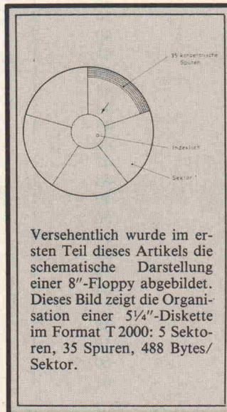
Versichtlich wurde im ersten Teil dieses Artikels die schematische Darstellung einer 8"-Floppy abgebildet. Dieses Bild zeigt die Organisation einer 5 1/4"-Diskette im Format T 2000: 5 Sektoren, 35 Spuren, 488 Bytes/Sektor.
